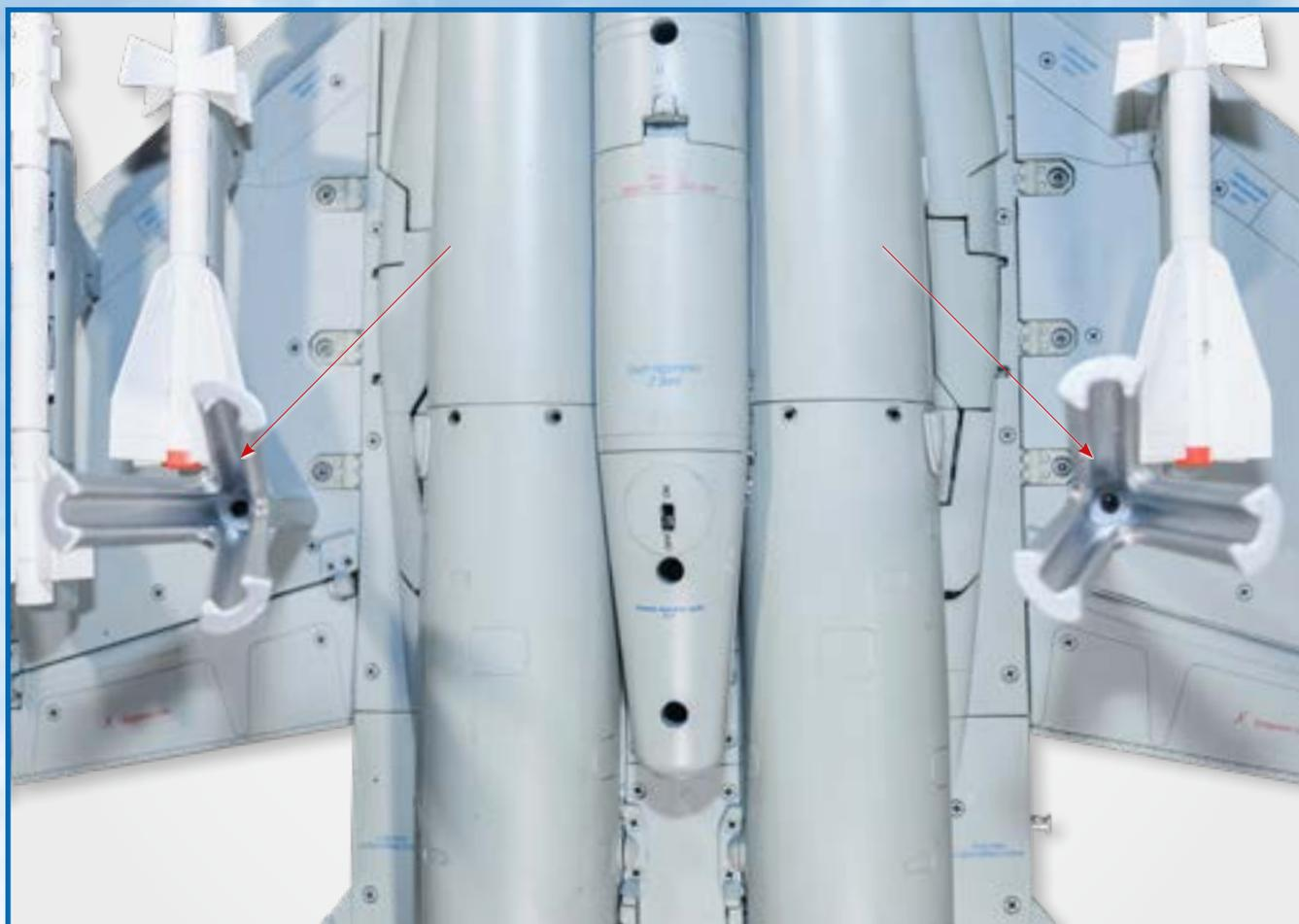
**6** Затем установите подкрыльевые опоры, как показано на снимке.
